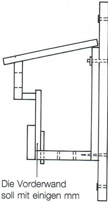
Die Vorderwand soll mit einigen mm Spielraum eingesetzt werden, um ein leichtes Herausnehmen, auch bei Feuchtigkeit, zu gewährleisten.
