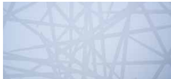
Die UV-reflektierenden Strukturen des Vogelschutzglases sind kaum sichtbar. Die hier zu erkennenden Strukturen konnten nur aus einem sehr spitzen Winkel aufgenommen werden
